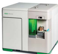
Bio-Rad S3 Cell Sorter 个人化流式分选仪，最多2激光（488/561）4色，100 \mu m喷嘴，两路分选。
